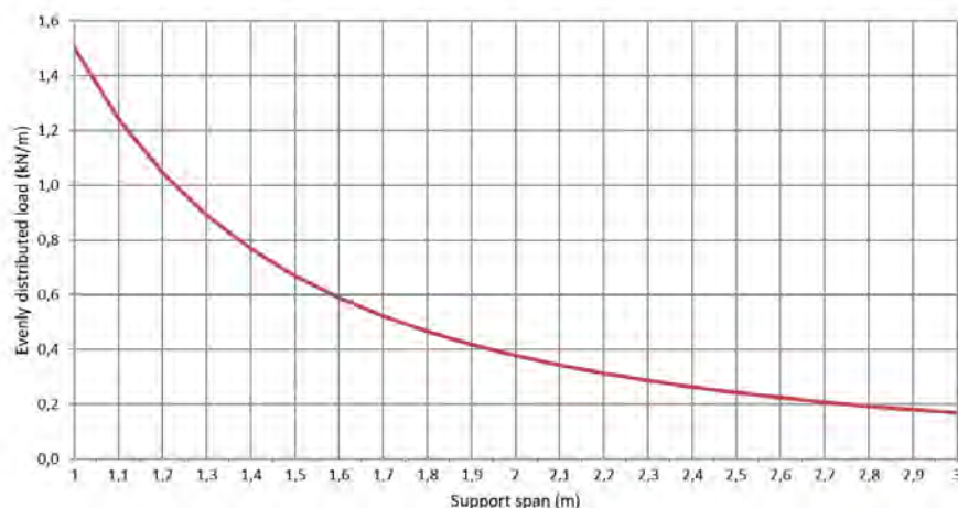
Permissible load KP 60/100 d=0,6mm (kN/m)
